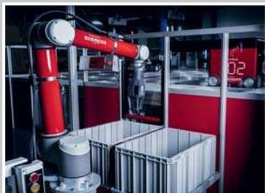
→ pour la vision et d'une "main" de préhension équipée d'une ventouse et de "doigts" mobiles. Ce cobot apprend en continu grâce aux machines learning : il sait déterminer en une fraction de seconde la méthode la plus rapide pour préparer les commandes.
