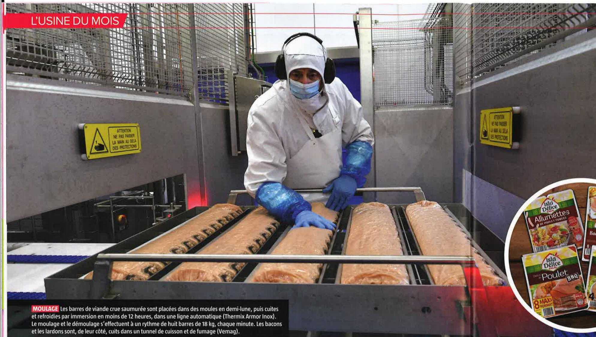
**MOULAGE** Les barres de viande crue saumurée sont placées dans des moules en demi-lune, puis cuites et refroidies par immersion en moins de 12 heures, dans une ligne automatique (Thermix Armor Inox). Le moulage et le démoulage s'effectuent à un rythme de huit barres de 18 kg, chaque minute. Les bacons et les lardons sont, de leur côté, cuits dans un tunnel de cuisson et de fumage (Vemag).
