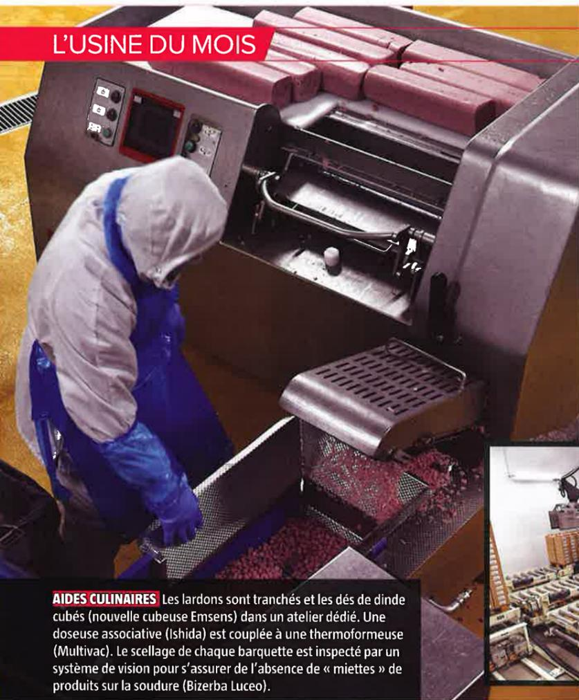
**AIDES CULINAIRES** Les lardons sont tranchés et les dés de dinde cubés (nouvelle cubeuse Emsens) dans un atelier dédié. Une doseuse associative (Ishida) est couplée à une thermoformeuse (Multivac). Le scellage de chaque barquette est inspecté par un système de vision pour s'assurer de l'absence de « miettes » de produits sur la soudure (Bizerba Luceo).
