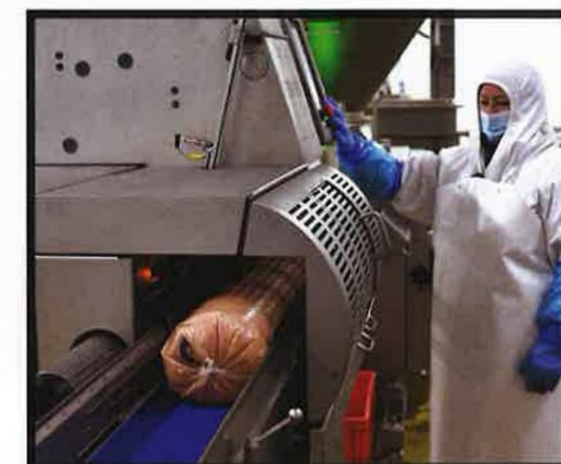
↑ **EMBOSSAGE** La viande de volaille crue saumurée est poussée vide (Handtman) dans un boyau synthétique clipé (Poly-clip) sous vide. La trémie est elle-même sous vide pour éviter la formation de bulles d'air inesthétique, notamment en bordure de tranche.
