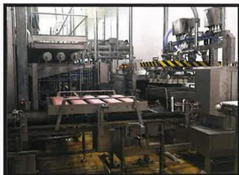
↑ **CUSSION** Les blocs de cinq barres sont empilés puis plongés dans une cuve en inox remplie d'eau chaude (cuisson à 78 °C à cœur), puis d'eau froide. La ligne a une capacité de 34 tonnes par jour.
