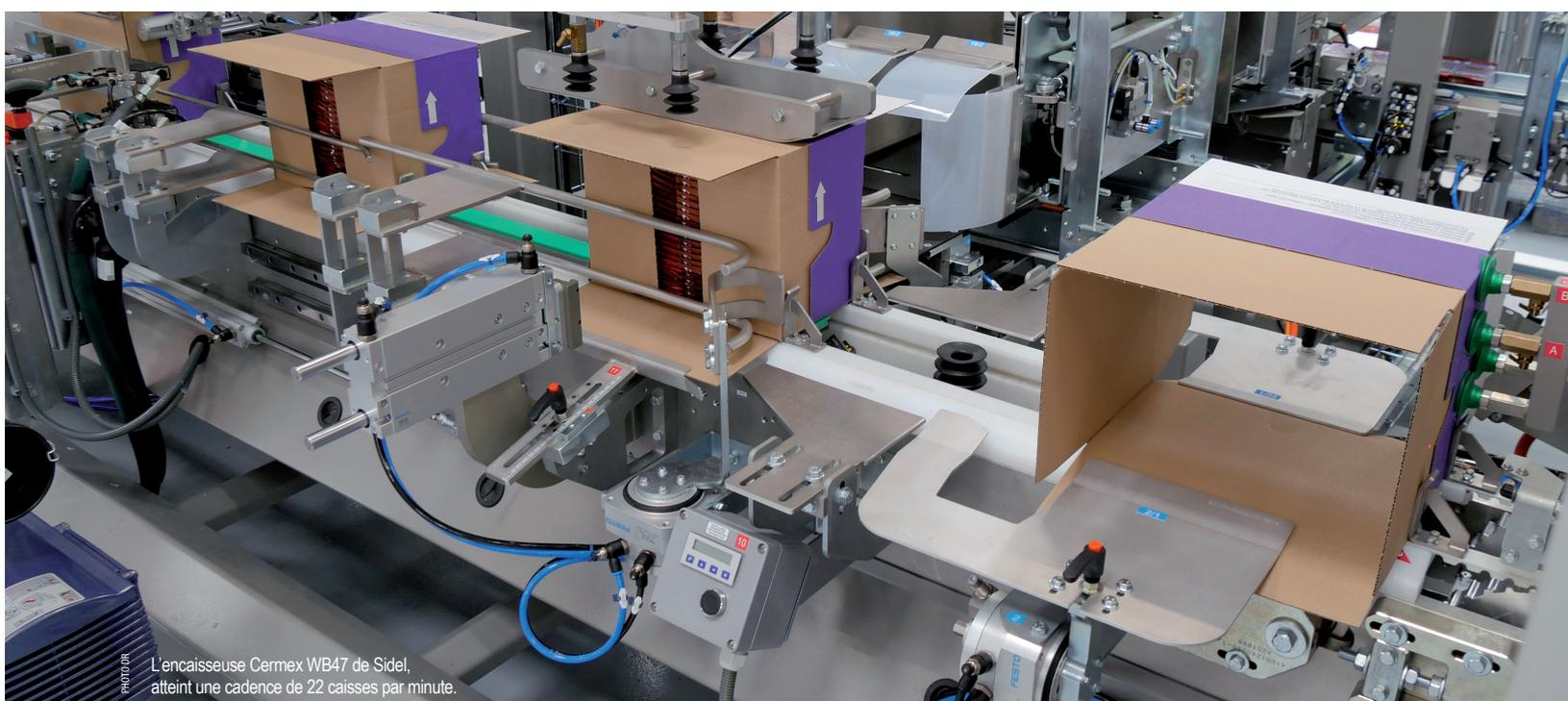
L'encaisseuse Cermex WB47 de Sidel, atteint une cadence de 22 caisses par minute.
